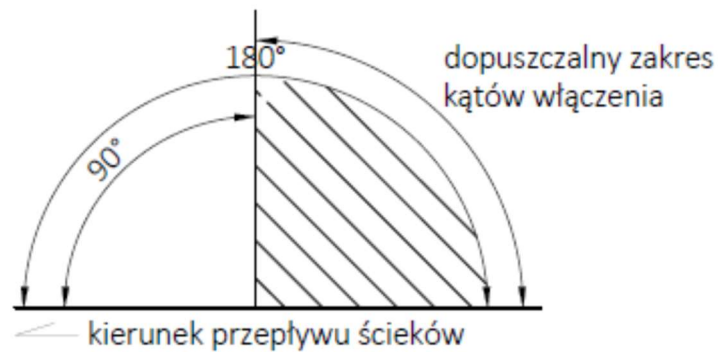
Rys. 4. Dopuszczalny zakres kątów włączenia kanału dopływowego
